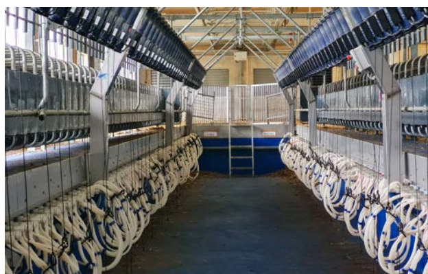
2 x 54-stands zij-aan-zij melkstal met automatische afname en melkmeting.
